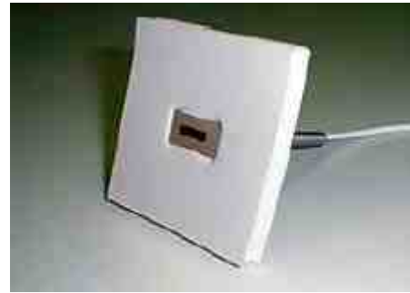
Рис. 17.3. Датчик температуры с изоляционным пенопластом и защитной пластиной
